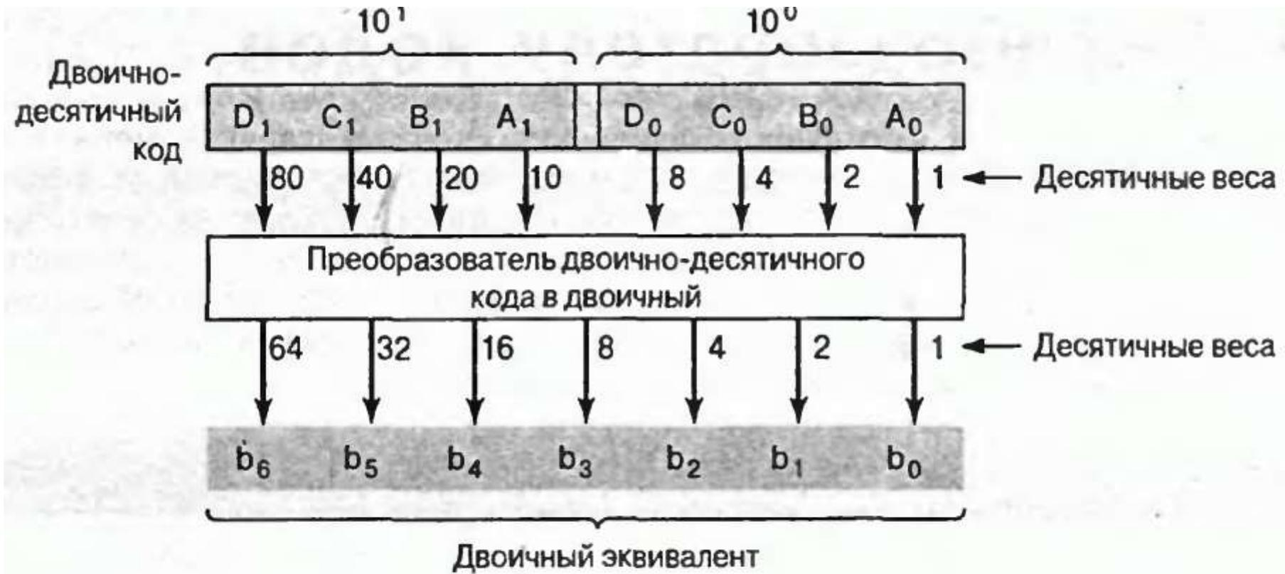
Рис. 9.39. Основной принцип работы преобразователя двухразрядного двоично-десятичного кода в двоичный код
