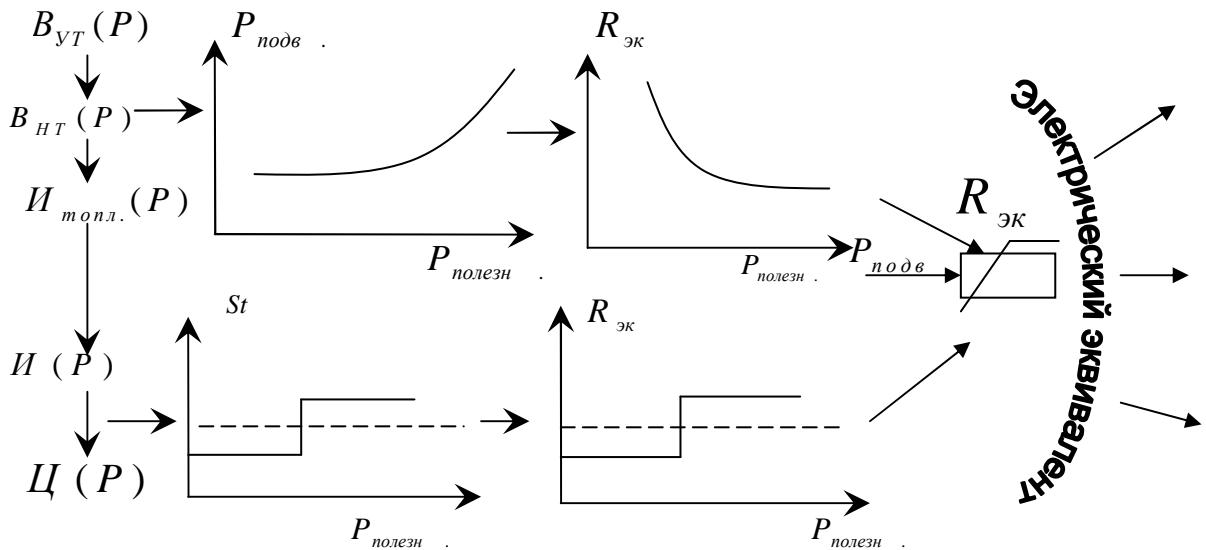
Рис. 3. Схема преобразования энергетических характеристик объектов в характеристику сопротивлений
