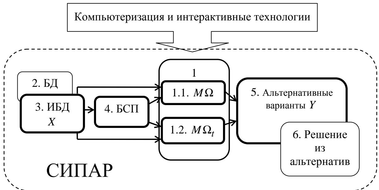
Рис. 1. Схема блоков системы СИПАР: БД – база данных, ИБД – информационная база данных, БСП – блок системы прогнозов,  $X$ ,  $Y$  – параметры входа и выхода для задачи
