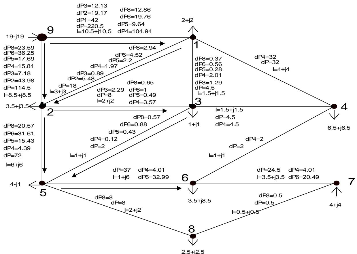
Рис. 2. Адресное распределение потерь мощности для тестовой схемы
