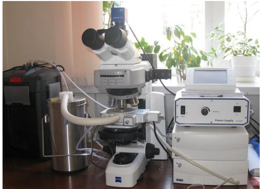
Поляризационный микроскоп Axio Scope.A1 с термокамерой Lincam для изучения флюидных включений
