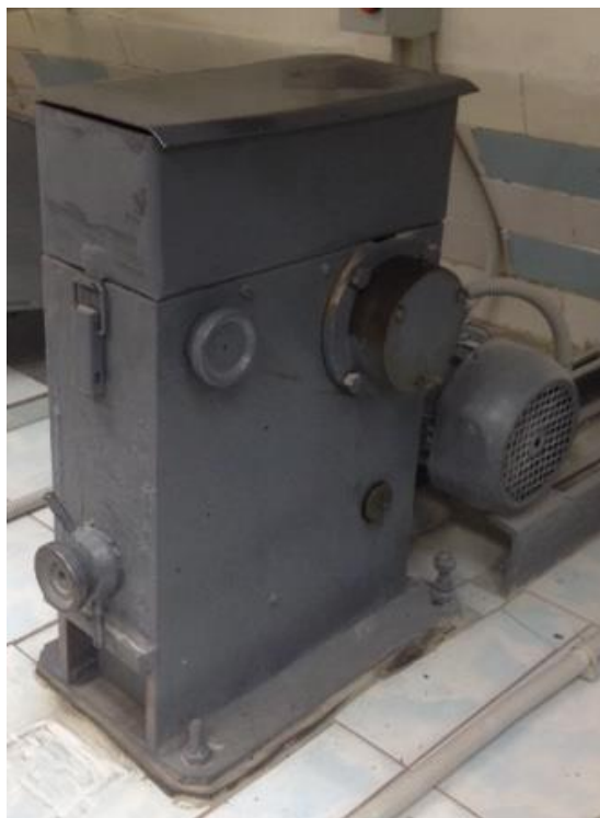
Дробилка щековая ЛДЩ-60/100 Крупность исходного материала не более 50 мм
