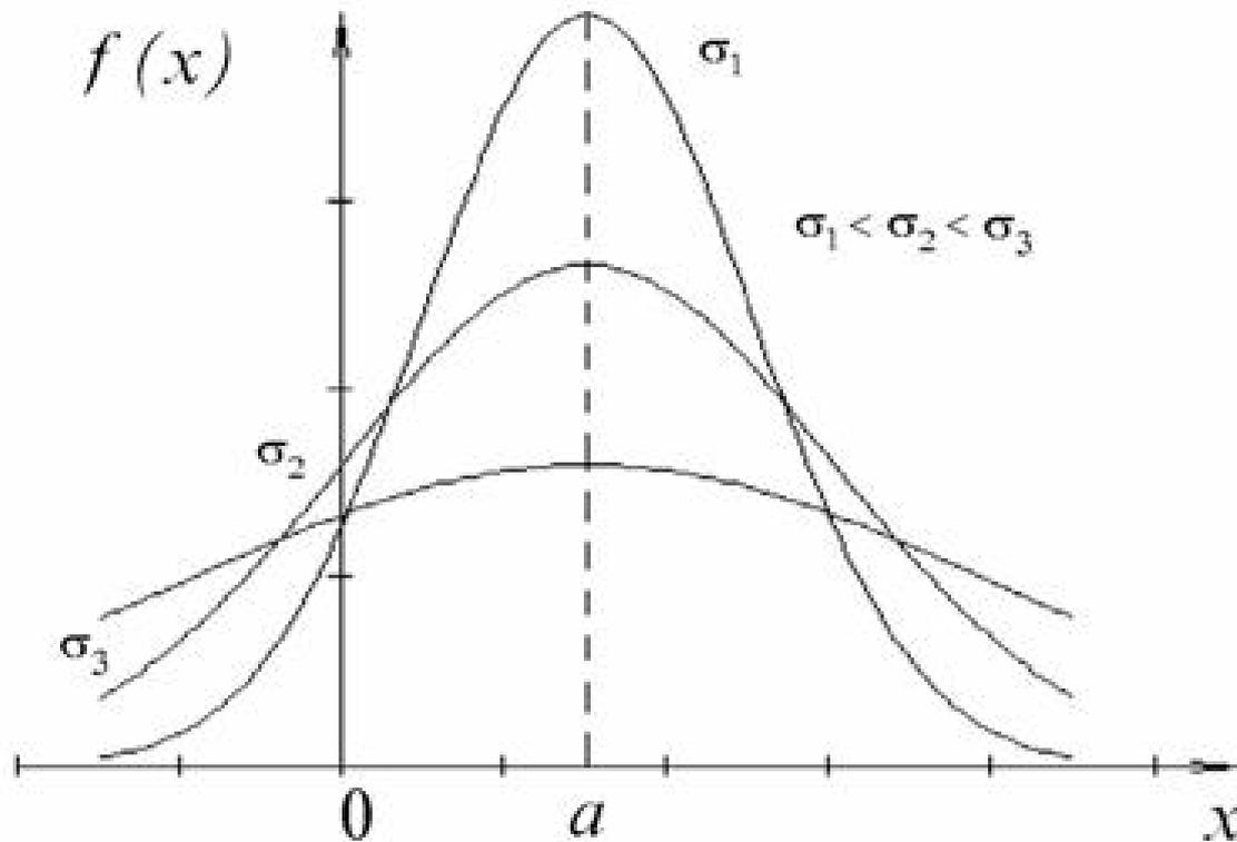
График функции  $f(x) = \frac{1}{\sigma\sqrt{2\pi}} \cdot e^{-\frac{(x-a)^2}{2\sigma^2}}$  называют **нормальной кривой (кривой Гаусса)**
