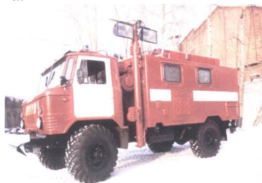
*Рис. 11.51. Автомобиль связи и освещения АСО–12 (66)*
