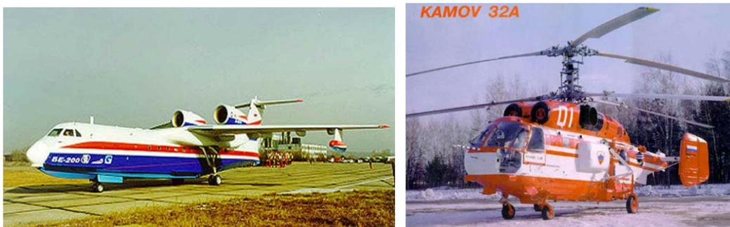
*Рис. 11.45. Пожарные самолет БЕ–200 и вертолет КА–32А*
