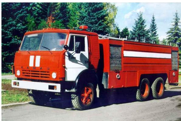
*Рис. 11.43. Пожарный автомобиль пенного тушения АВ-20 (53213)*
