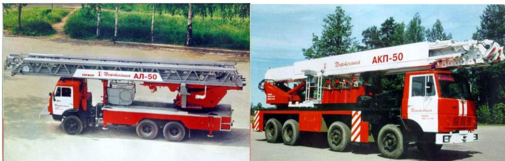
Рис. 11.47. Пожарная автолестница АЛ-50 (53228) ПМ-513 и коленчатый подъемник АКП-50 (6923)
