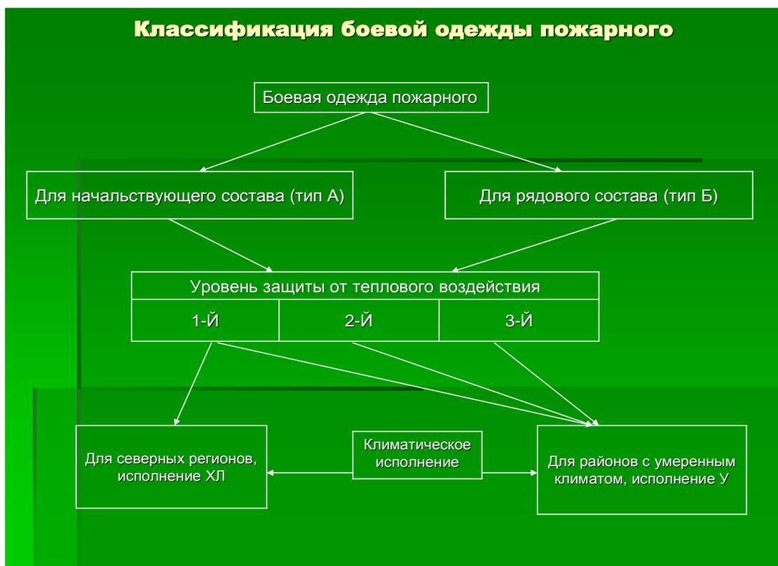
Рис. 7.2. Классификация боевой одежды пожарного
