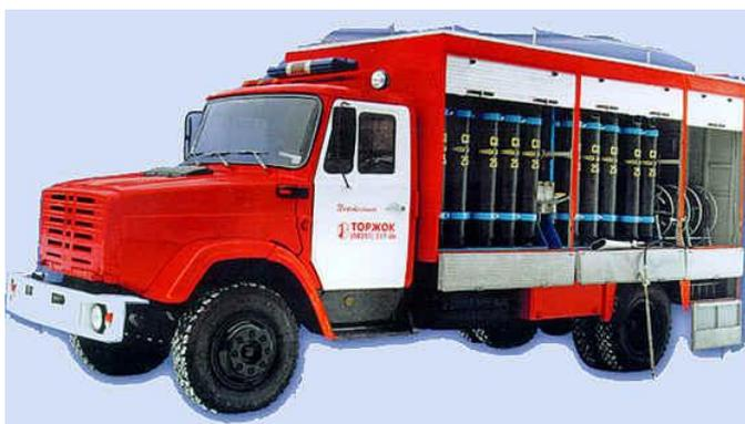
*Рис. 11.44. Автомобиль газового тушения АГТ–1000 (4331)*
