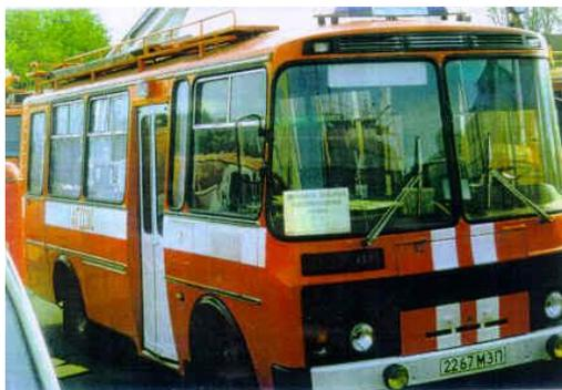
Рис. 11.52. Автомобиль газодымозащитной службы АГ-12 (3205)
