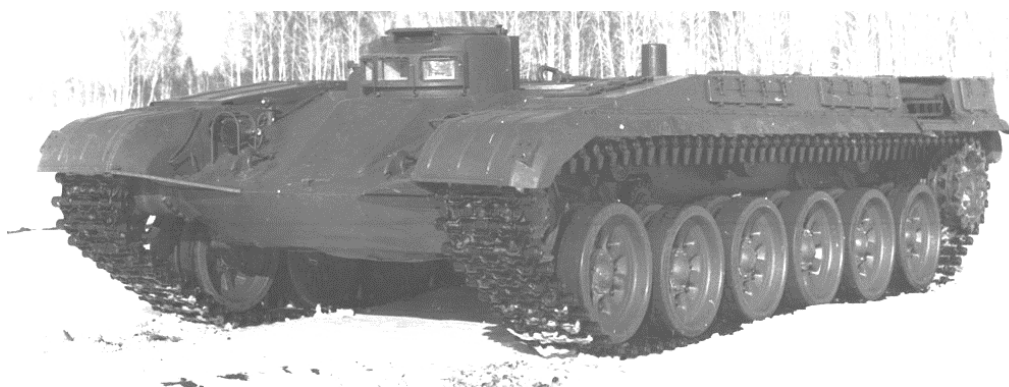
Рис. 1.4. Гусеничное бронированное шасси машины разграждения (общий вид)
