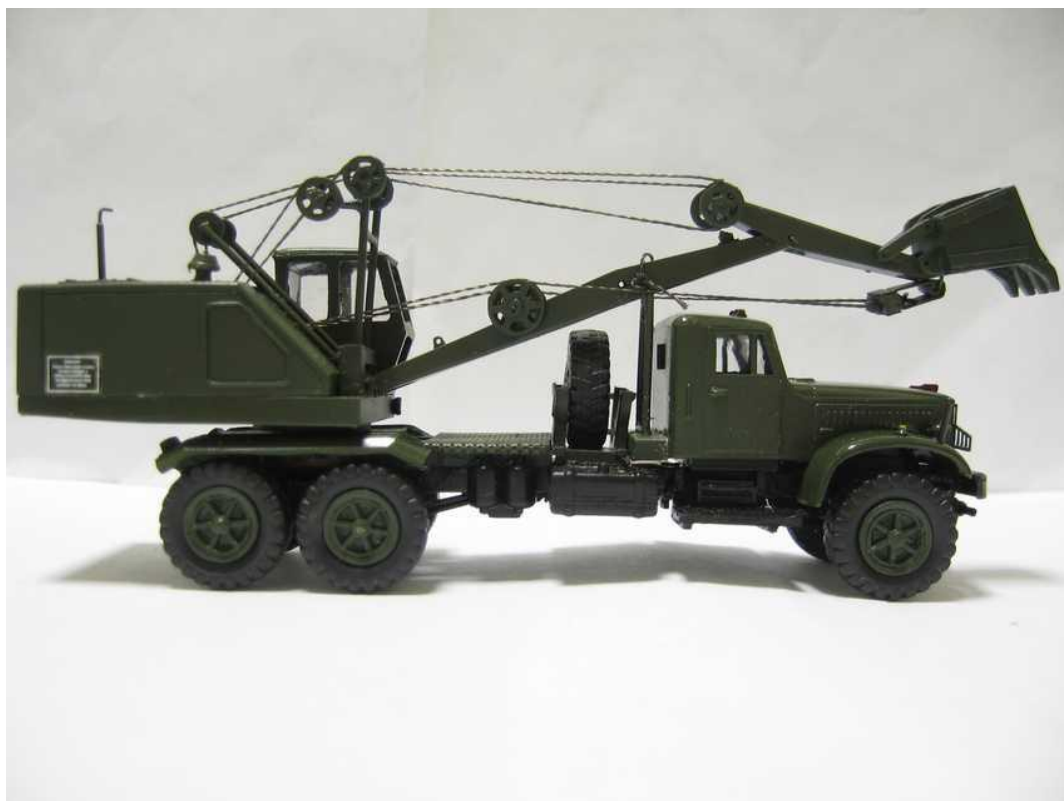
Рис.2.15. Экскаватор Э-305В. Транспортное положение
