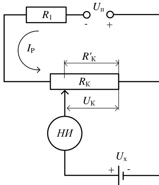
Рисунок 1.19. Принципиальная схема измерения ЭДС компенсационным методом
