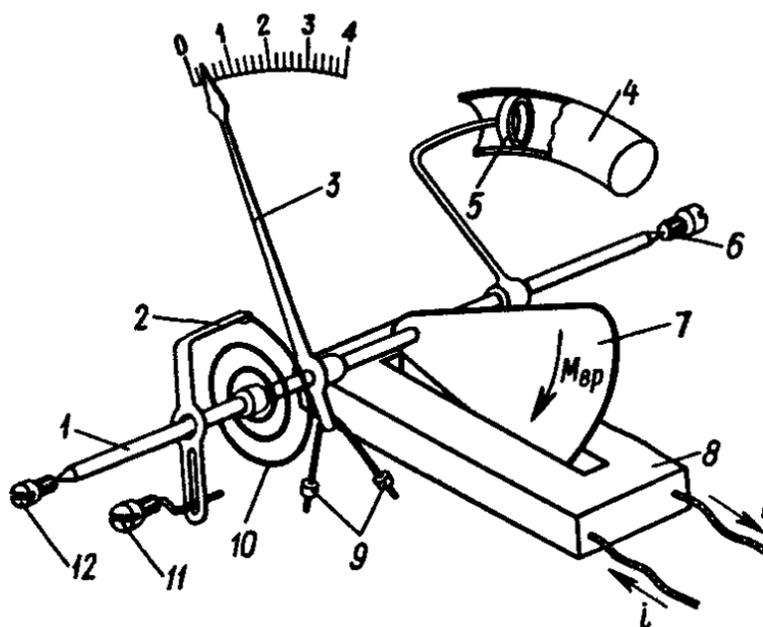
Рис. 1.2 Конструкция электромагнитного вольтметра:
