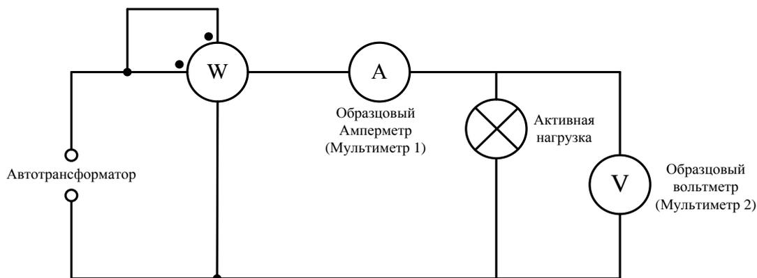
Рисунок 1.15 Схема экспериментальной цепи
