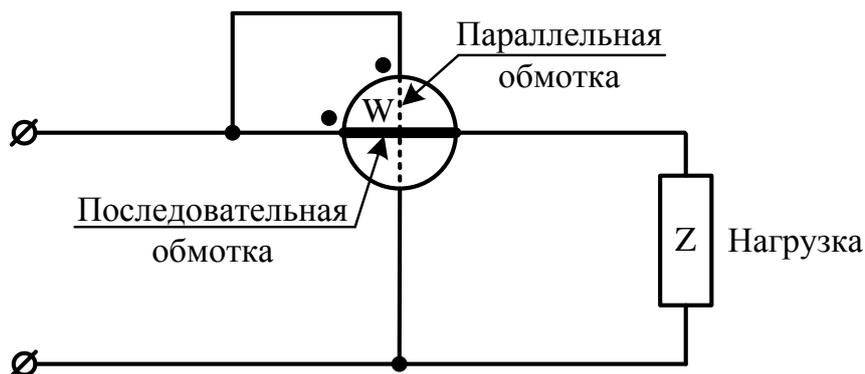
Рисунок 1.14 Ваттметр в составе электрической схемы
