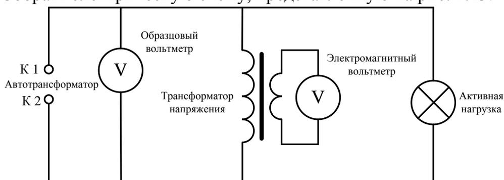
Рисунок 1.13 Схема экспериментальной цепи
