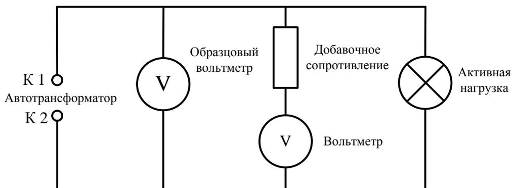
Рисунок 1.10 Схема экспериментальной цепи
