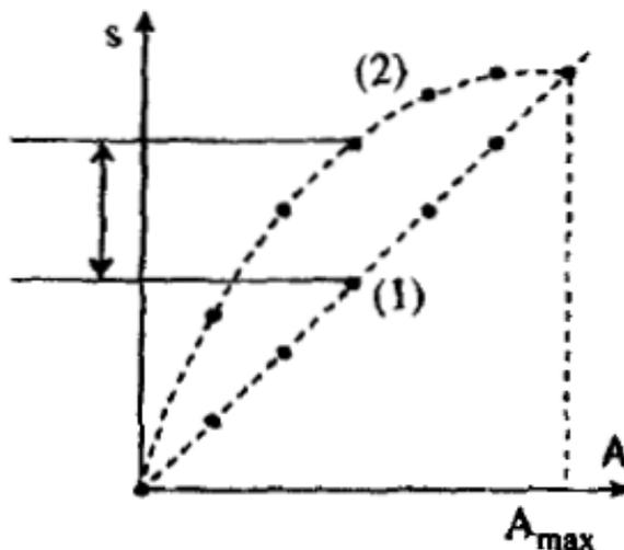
Рис. 1.22. Искажение линейности ЦАП:
