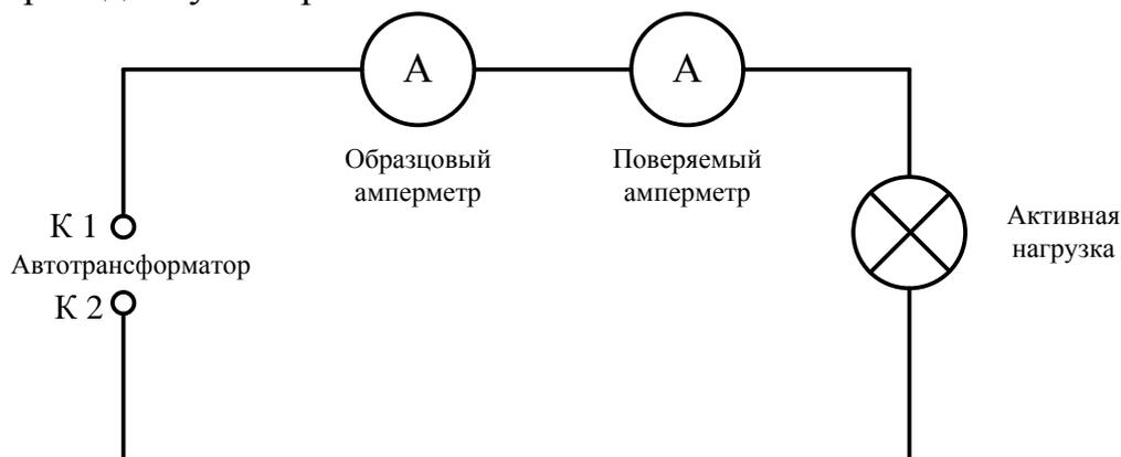
Рисунок 1.6 Схема экспериментальной цепи
