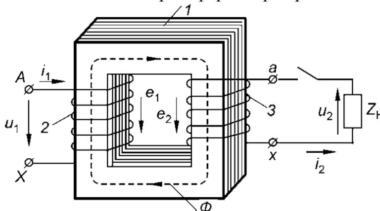
Рисунок 1.11. Электромагнитная схема трансформатора
