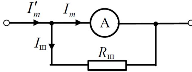
Рисунок 1.7 Схема подключения шунта к амперметру
