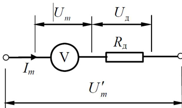
Рисунок 1.8 Схема подключения шунта к вольтметру
