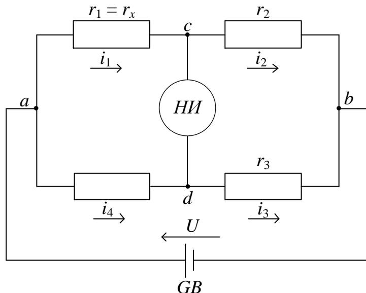
Рисунок 1.17. Схема моста постоянного тока
