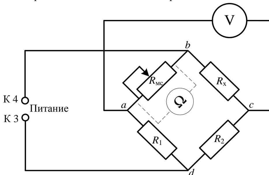
Рисунок 1.18 Схема экспериментальной цепи
