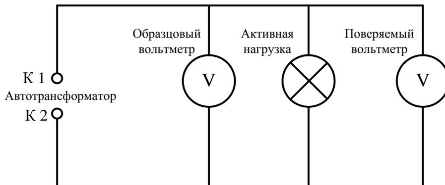
*Рис. 1.3. Схема экспериментальной цепи*
