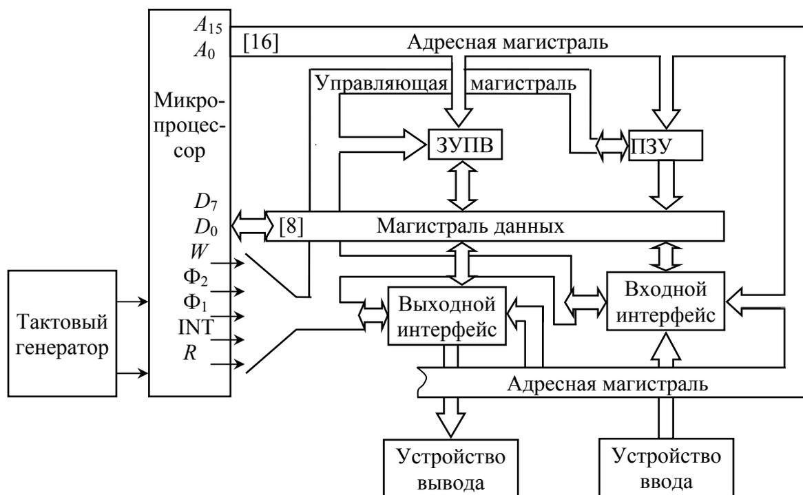
Рис. 3.74. Структурная схема микроЭВМ
