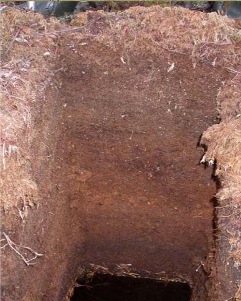
**Верхние горизонты до глубины 72 см (уровень стабильного стояния грунтовых вод) взяты в виде монолита 20x20 см и разделены на интервалы с шагом 2 см.**
