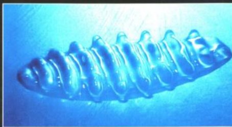
Если поместить капли на предметное стекло и подвергнуть воздействию колебаний, например, мембраны динамика, они образуют формы и узоры, напоминающие представителей животного и растительного мира. Это происходит благодаря сильному поверхностному натяжению H_2O .
