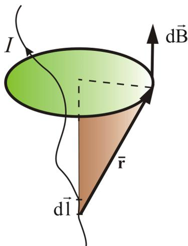
Здесь  $I$  – ток;  $d\vec{l}$  – вектор, совпадающий с элементарным участком тока и направленный в ту сторону, куда течет ток;  $\vec{r}$  – радиус-вектор, проведенный от элемента тока в точку, в которой мы определяем  $d\vec{B}$ ;  $r$  – модуль радиус-вектора;  $k$  – коэффициент пропорциональности, зависящий от системы единиц.
