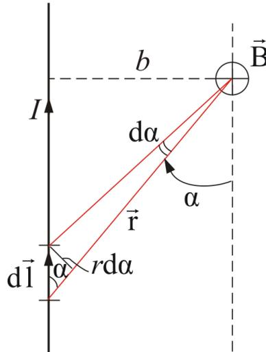
Все векторы  $d\vec{B}$  от произвольных элементарных участков  $d\vec{l}$  имеют одинаковое направление. Поэтому сложение векторов можно заменить сложением модулей.
