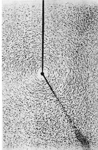
Так было установлено, что силовые линии магнитного поля прямолинейного проводника с током – это концентрические окружности с центрами на проводнике, лежащие в плоскости, перпендикулярной проводнику.
