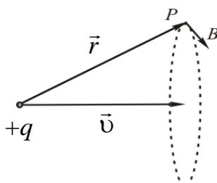
Выражение (16) определяет индукцию магнитного поля, создаваемого одним зарядом, движущимся со скоростью  $\vec{v}$  в точке, положение которой относительно заряда определяется радиусом – вектором  $\vec{r}$ . Из соотношения (16) вытекает, что вектор  $\vec{B}$  в каждой точке  $P$  направлен перпендикулярно к плоскости, проходящей через направление вектора  $\vec{v}$  и точку  $P$ , причем так, что вращение в направлении  $\vec{B}$  образует с направлением  $\vec{v}$  правовинтовую систему.
