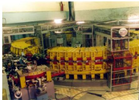
Внешний вид Томского синхротрона на 1,5 ГэВ представлен на рисунке. Электроны в разных синхротронах ускоряются до энергий 5 – 10 ГэВ.
