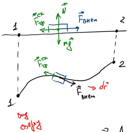
$$\vec{F}_{\text{тр}}^{\text{ск}} = \mu \cdot N \quad \mu - \text{коэф. трения}$$
