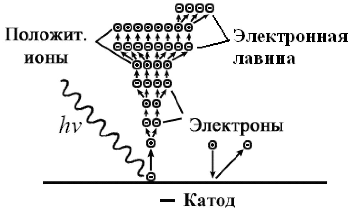
*Электрический пробой* газа – процесс при котором несамостоятельный разряд переходит в самостоятельный .
