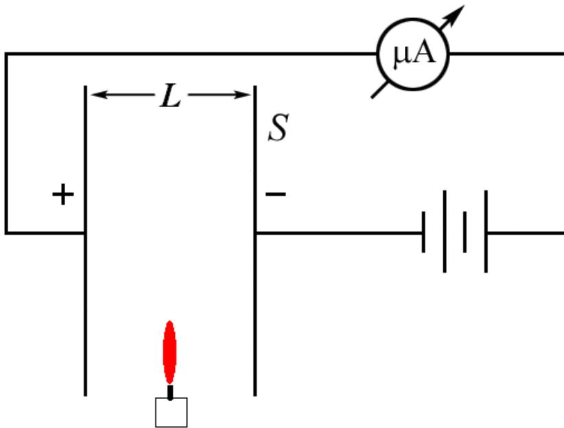
Если в газовый промежуток длиной  $L$  между двумя пластинаами площадью  $S$  внести пламя свечи, то во внешней цепи будет протекать ток. Если пламя убрать – ток исчезает.
