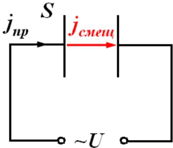
Постулируется: линии тока проводимости на границах обкладок конденсатора переходят в линии тока смещения.
