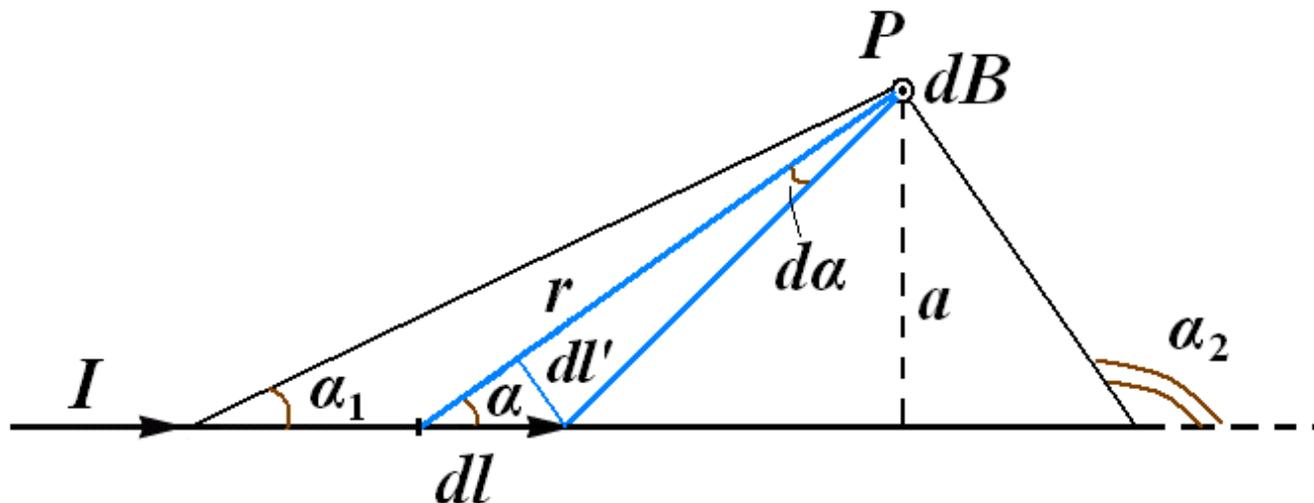
Поле в точке  $P$ , расположенной на расстоянии  $a$  от проводника конечной длины с током  $I$ .
