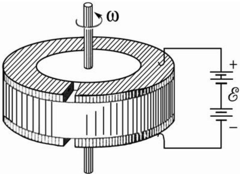
Взаимодействие конвекционного тока на движущемся проводнике и тока связанных зарядов, возникающего при движении наэлектризованного диэлектрика с магнитной стрелкой.
