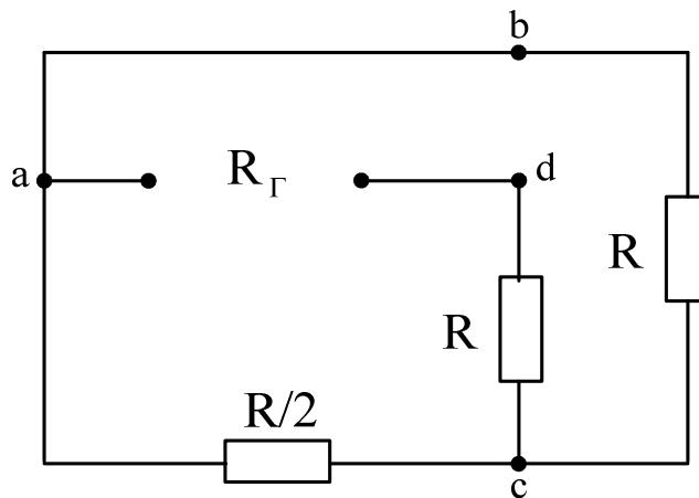
Рис.8. К определению сопротивления эквивалентного генератора
