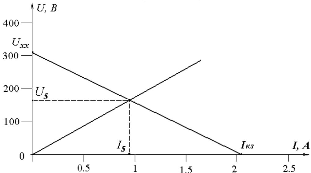
Рис. 9. Графическое определение тока  $I_5$  и напряжения  $U_5$  на сопротивлении  $2R$
