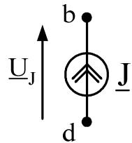
Рис.15в. К построению вектора напряжения на источнике тока
