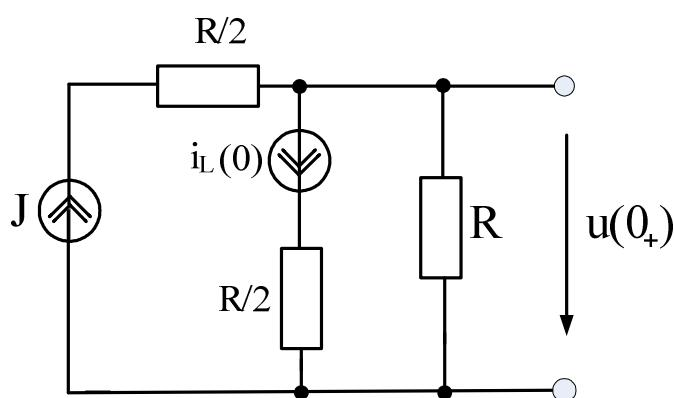
Рис.18. Схема для расчета ЗНУ
