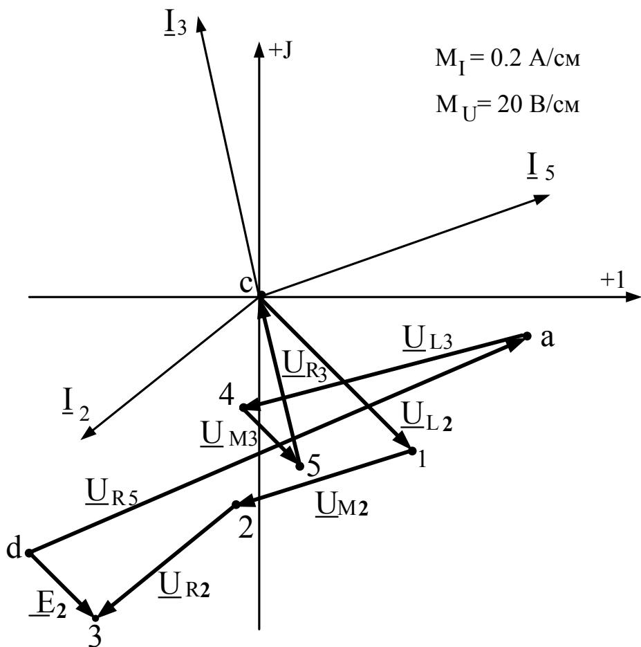
Рис.16. Лучевая диаграмма токов и топографическая
