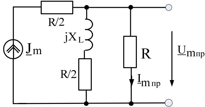
Рис.24. Схема для расчета принужденной составляющей
