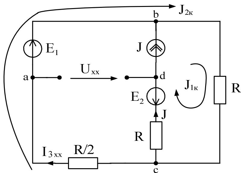
Рис.7. Эквивалентный генератор в режиме холостого хода
