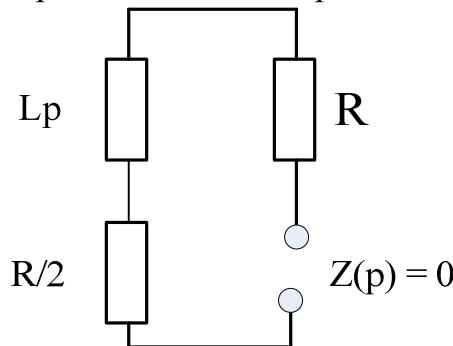
Рис.19. Схема для определения  $Z(p)$
