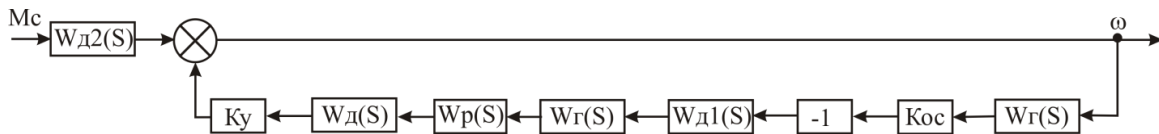
Рис. 1.12. Структурная схема САР по возмущающему фактору
