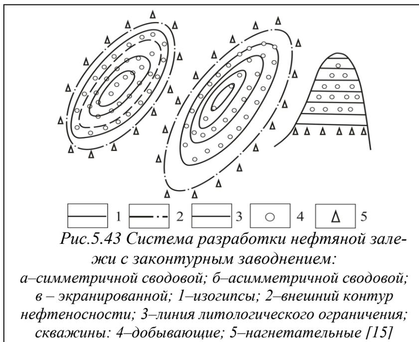
Системы разработки с законтурным заводнением, кроме того, рекомендуется применять при разработке групп близко расположенных, небольших по размерам нефтяных залежей (залежей-спутников), когда нагнетательные скважины, расположенные за контуром нефтеносности, оказывают при закачке воды влияние одновременно на несколько залежей.
