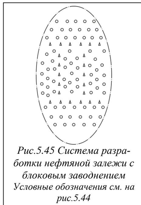
Рис.5.45 Система разработки нефтяной залежи с блоковым заводнением
