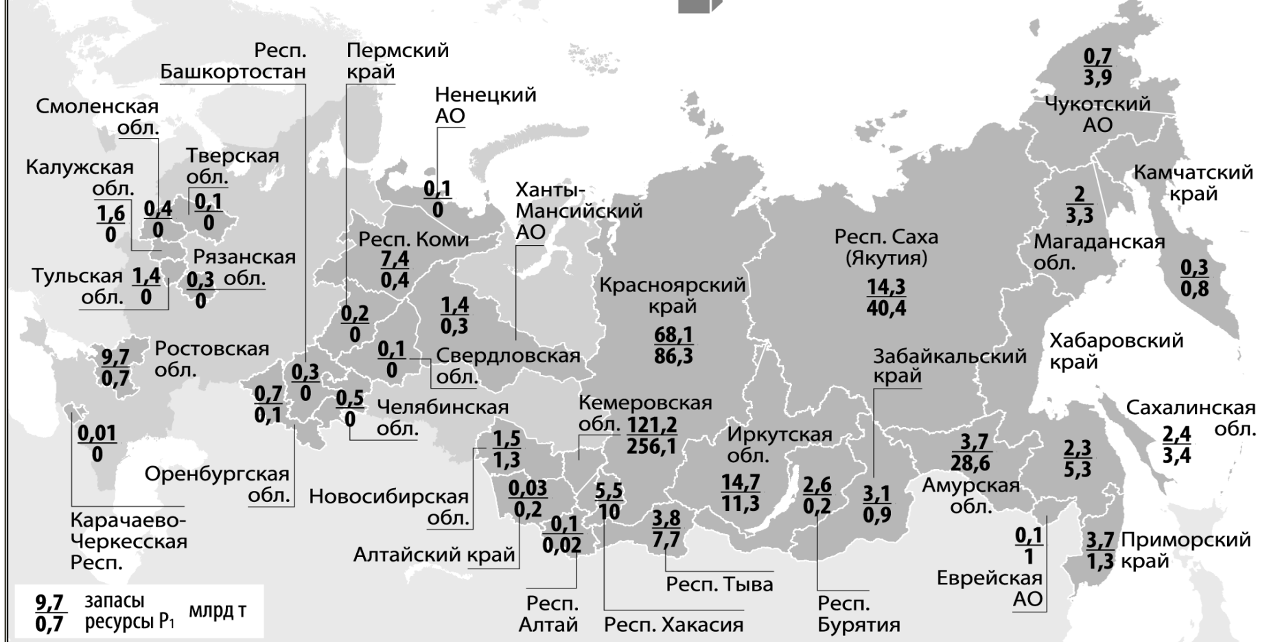
Распределение запасов углей и их прогнозных ресурсов категории P 1 по субъектам Российской Федерации, млрд т
