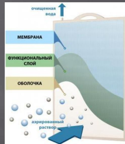
Установка ультраfiltrации на полволоконных мембранах
