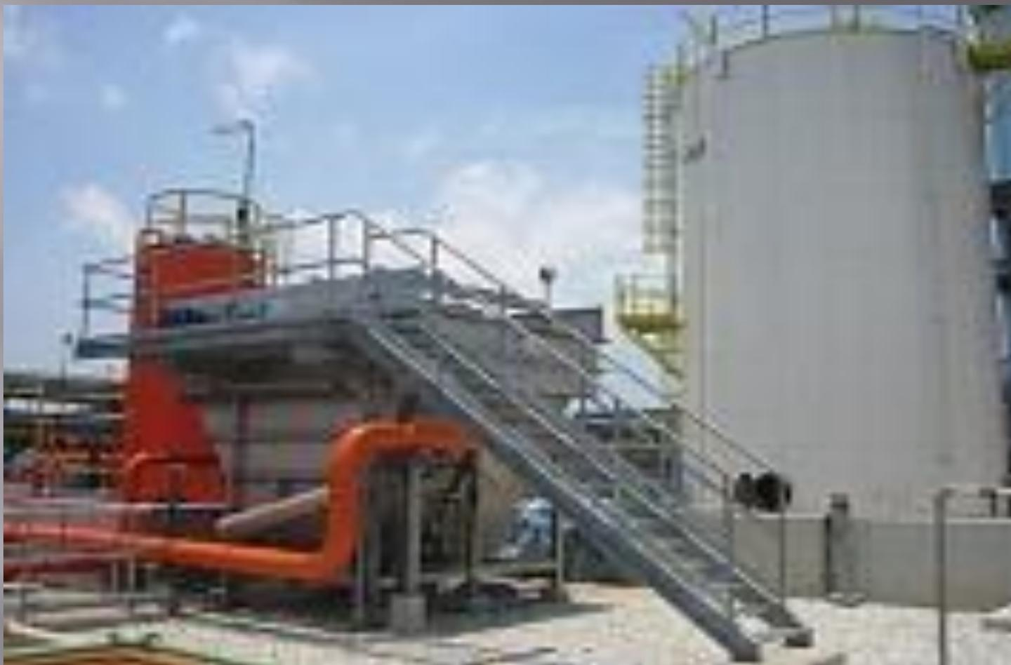
Емкостной реактор (реакционная емкость) для процессов коагуляции и флокуляции
