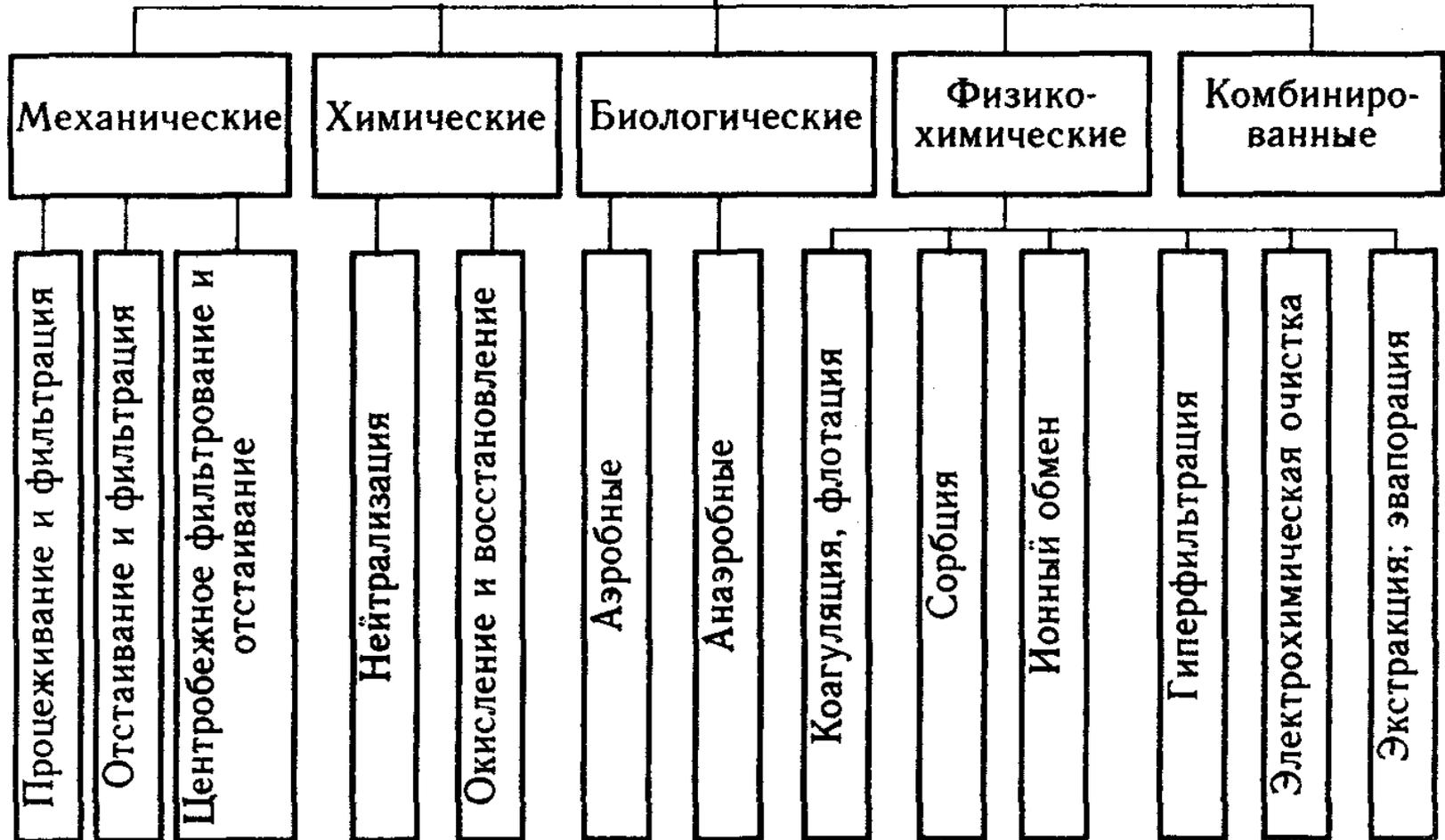
Классификация методов очистки промышленных сточных вод
