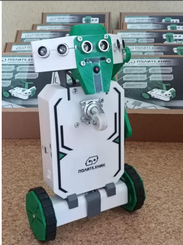
Рисунок 8.18. Робот с установленным подъемным рычагом
