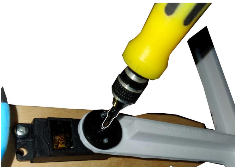
Рисунок 4.17 Установка рычага в сервомотор робота
