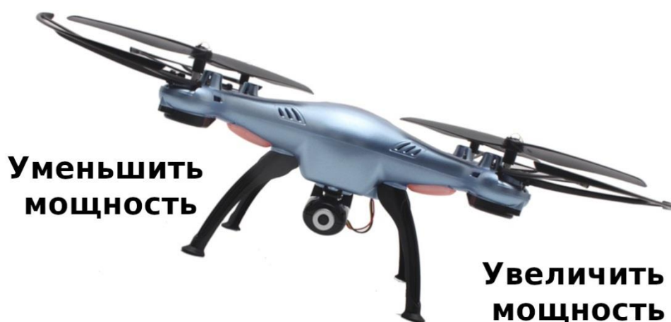
Рисунок 4.1. Квадрокоптер в режиме рассогласования мощности моторов
