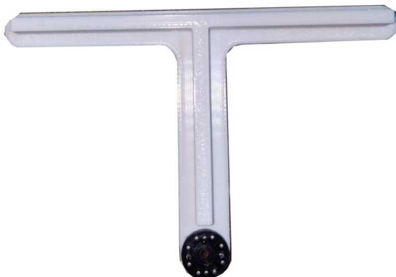
Рисунок 4.16. Рычаг подъёмный с установленным фланцем
