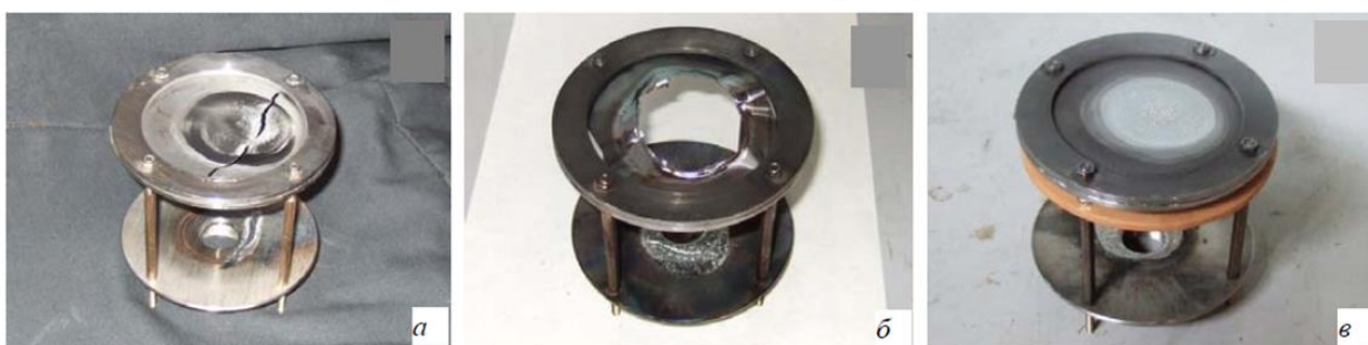
Рисунок 3. Состояние мишеней после облучения сильноточным РЭП (микросекундный ствол): а – мишень из W ( d=200 мкм, 2 выстрела), б – мишень из Ta ( d=50 мкм, 3 выстрела); в – мишень из Mo ( d=500 мкм, 15 выстрелов).
