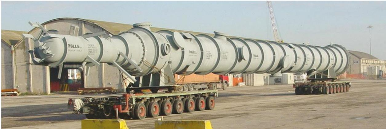
Диаметр – 2,4 м; Высота – 39 м; толщина стали – 30 мм; вес – 100 т.
