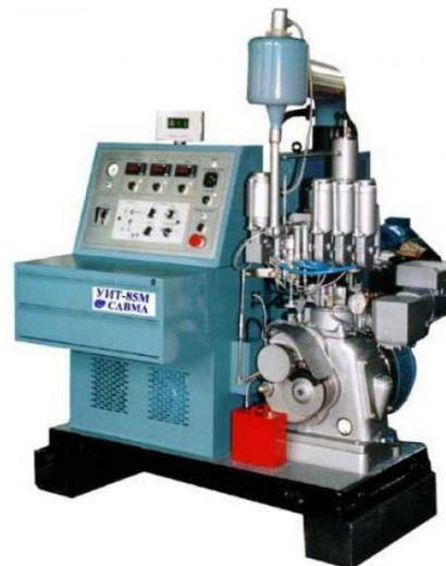
Установка УИТ-85 для определения октанового числа по моторному и исследовательским методам (арбитражная методика)
