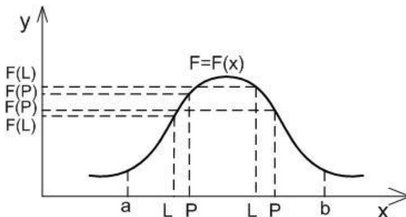
Рисунок 5.3 Графическое представление метода деления отрезка пополам
