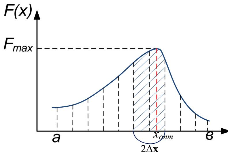
Рисунок 5.5 Графическое представление метода сканирования
