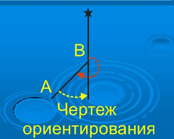
2. Измерение углов ориентирования на карте или плане в плоской системе координат Гаусса-Крюгера
