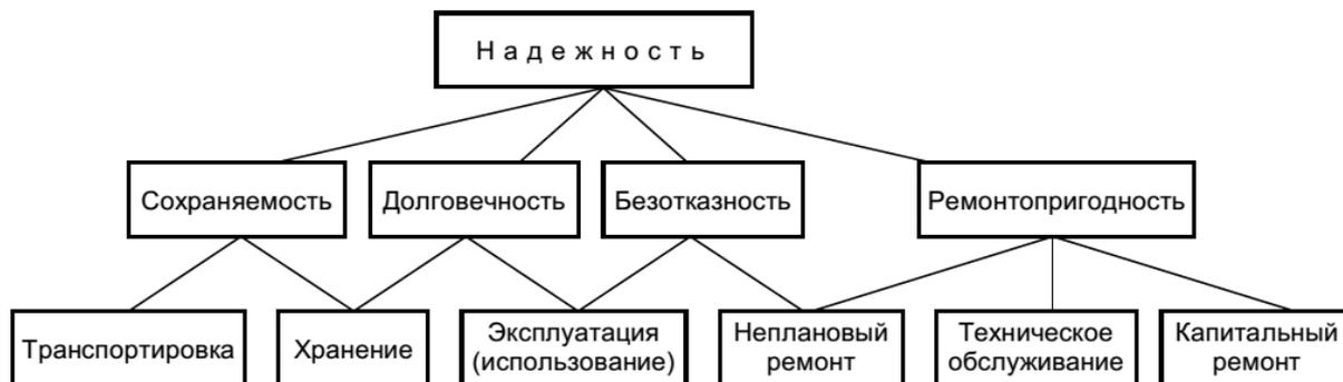
Рис. 1.1. Схема взаимосвязей свойств надежности и этапов жизненного цикла
