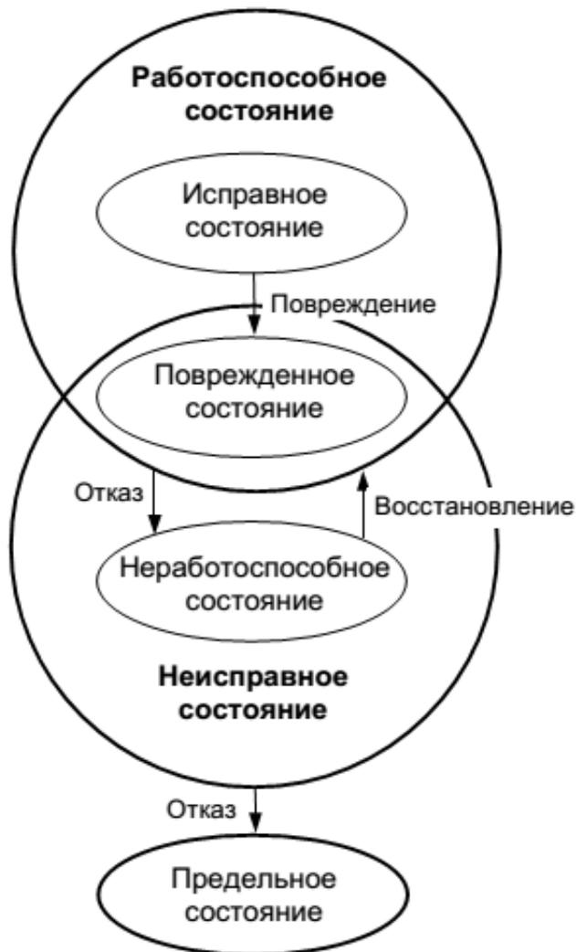
Рис. 1.2. Схема состояний и событий в процессе эксплуатации объекта
