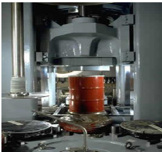
Рис. 21. Установка по прессованию радиоактивных отходов
