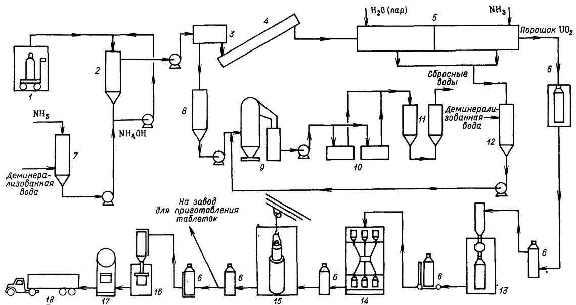
Рис. 10. Аппаратурная (АДУ) схема процесса получения таблетированной  $UO_2$
