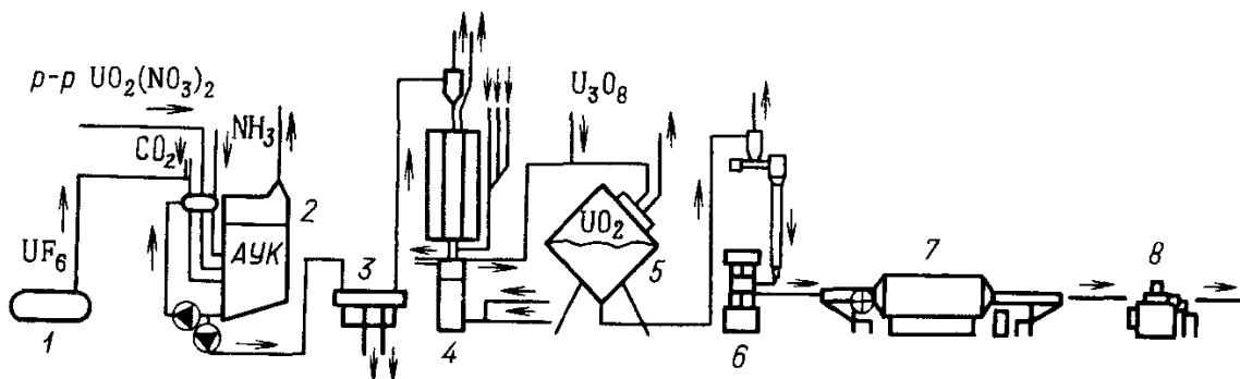
**Рис. 11. Аппаратурная (АУК) схема получения таблетированного топлива**
