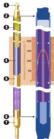
*Рис. 13 Твэл реактора ВВЭР-1000*
