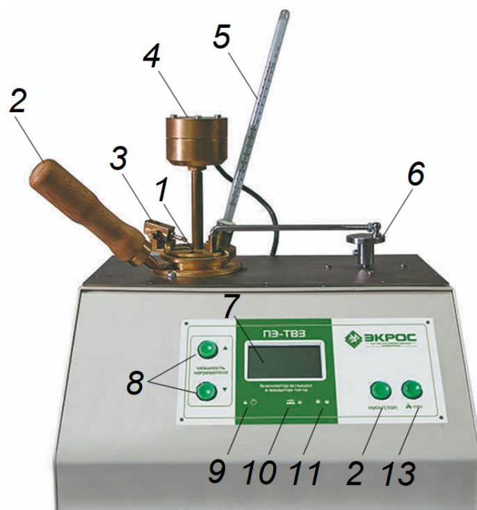
Рис. 2.11. Внешний вид аппарата полуавтоматического ПЭ-ТВЗ для определения температуры вспышки в закрытом тигле:
