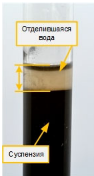
Рис. 2.20. Внешний вид суспензии при применении метода WSR
