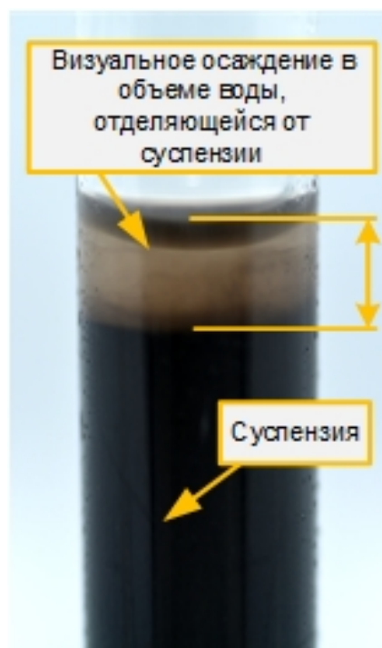
Рис. 2.22. Внешний вид суспензии при использовании метода расчета средней скорости осаждения твердых частиц
