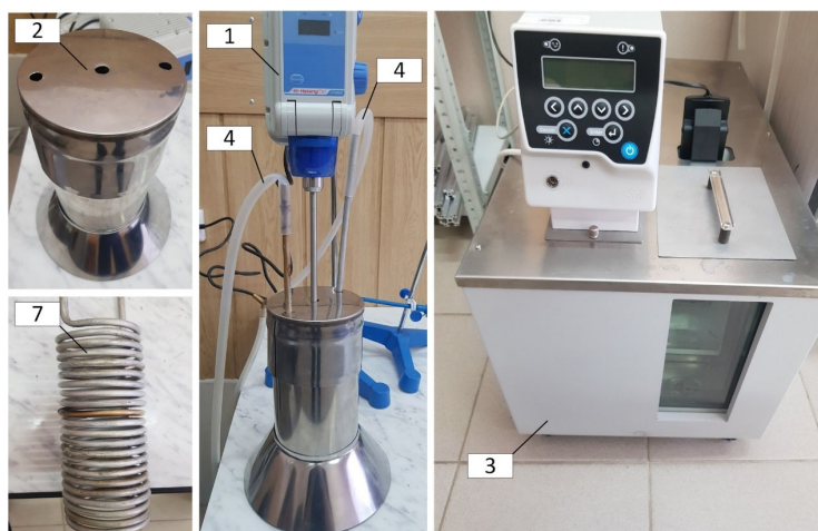
Рис. 1.18. Схема (а) и фото (б) экспериментального стенда для производства биотоплива с помощью наномембранного реактора: 1 – верхнеприводная мешалка; 2 – бак для сбора биотоплива; 3 – термостат жидкостный; 4 – внешний контур термостата; 5 – наномембранный реактор; 6 – смесь исходных компонентов; 7 – спиралевидный нагревательный элемент; 8 – лабораторный термометр
