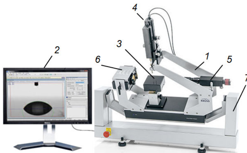
Рис. 2.24. Внешний вид оборудования для измерения краевого угла смачивания методом лежащей капли:
