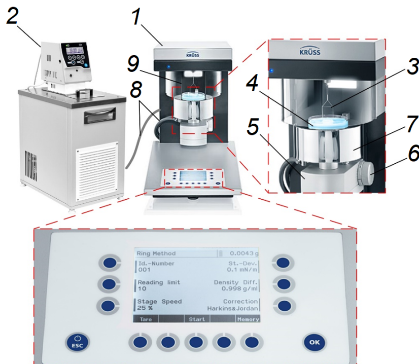
Рис. 2.7. Внешний вид оборудования для измерения поверхностного и межфазного натяжения методом кольца Дю Нуи:
