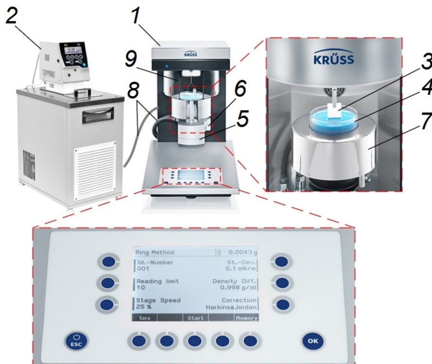
Рис. 2.8. Внешний вид оборудования для измерения поверхностного и межфазного натяжения методом пластины Вильгельма: 1 – тензиометр; 2 – термостат жидкостный; 3 – пластина Вильгельма; 4 – сосуд для образцов; 5 – подвижный столик; 6 – регулятор уровня; 7 – термостатируемая рубашка; 8 – внешний контур термостата; 9 – термопара
