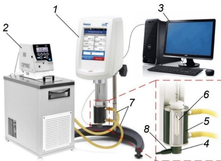
Рис. 2.4. Внешний вид оборудования для измерения динамической вязкости: 1 – ротационный вискозиметр; 2 – термостат жидкостный; 3 – ПК; 4 – емкость с исследуемым образцом; 5 – SSA-адаптер; 6 – шпindelь; 7 – внешний контур термостата; 8 – термопара
