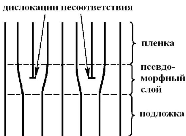
Рис.5.11 Схема образования псевдоморфного слоя и дислокаций несоответствия при эпитаксиальном росте пленки
