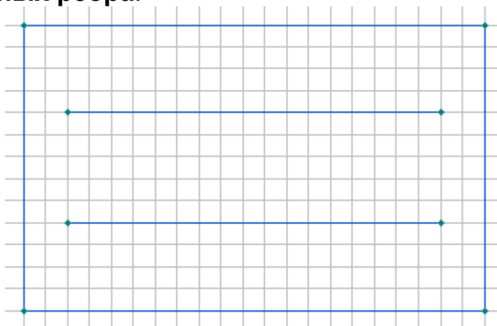
Рисунок 46. Геометрическая модель объекта (две обкладки и экран).
