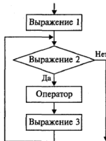
Рисунок 81. Алгоритм выполнения цикла for .
