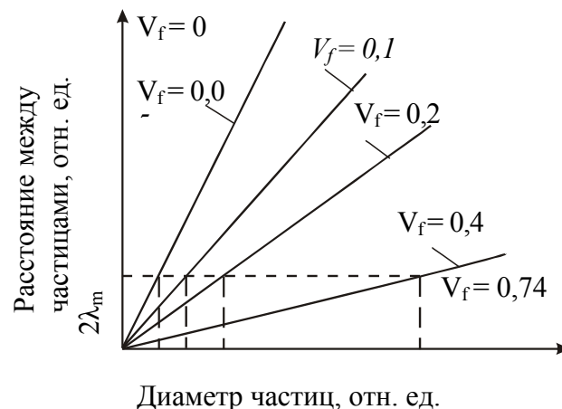
Рис. 13.5. Зависимость расстояния ( d ) между частицами от их диаметра ( D ) при различных V_f
