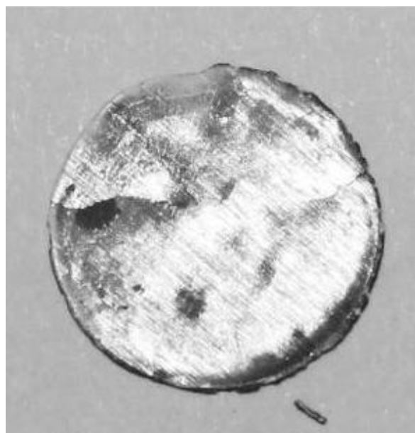
Рисунок 5 – Увеличенная фотография образца АСв после сбрасывания груза массой 10 кг с высоты 500 мм
