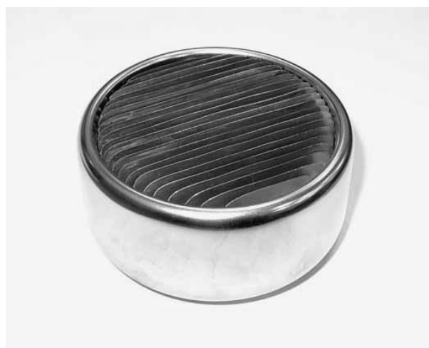
Рис. 18. Многолезвийный металлодиэлектрический катод, использованный в конструкции виркатора дециметрового диапазона длин волн
