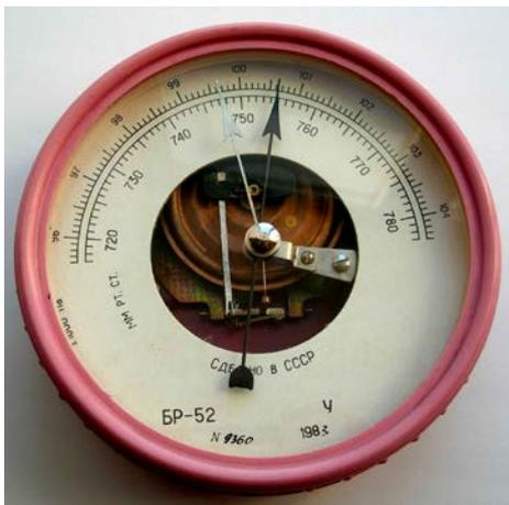
Рис. 16. Барометр-анероид
