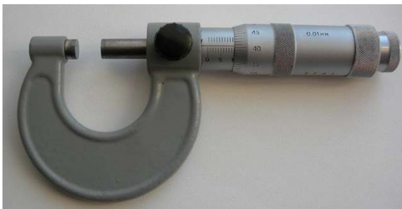
Рис. 13. Микрометр
