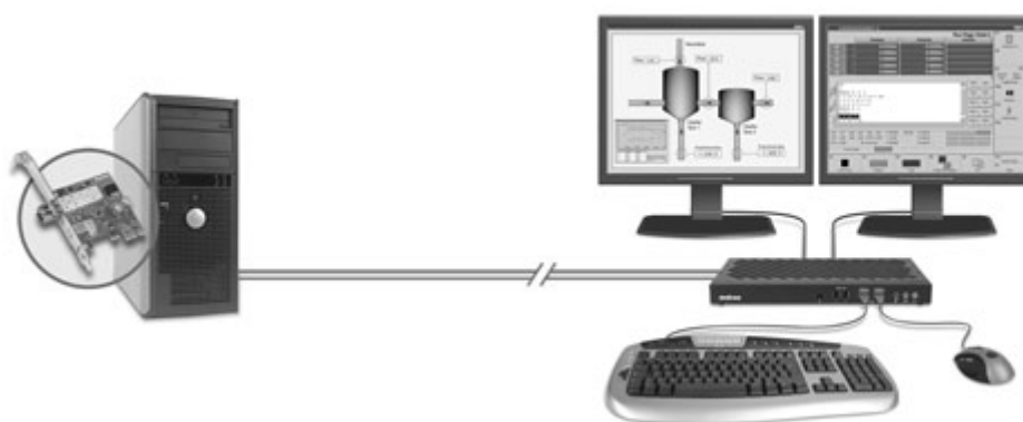
Рис. 1.5. Вид системы удалённого графического управления в сборе
