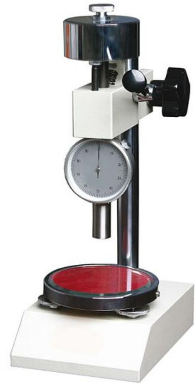
Твёрдость по Шору (метод вдавливания) — твёрдость определяется по глубине проникновения в материал специальной закаленной стальной иглы (индентора) под действием калиброванной пружин
