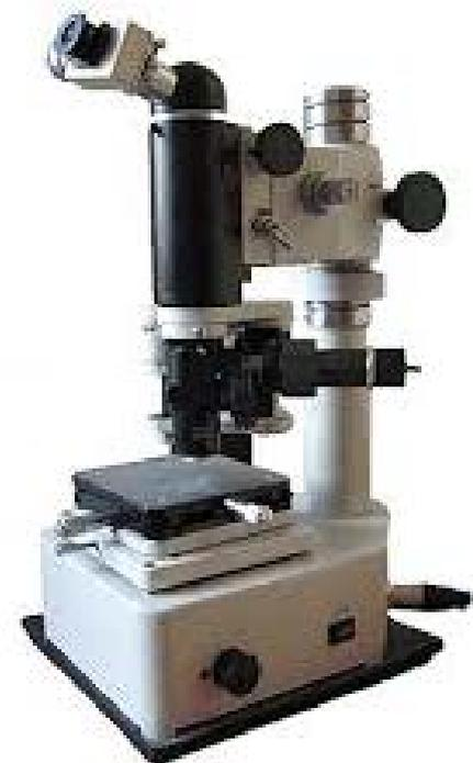
Твёрдость, определённая по этому методу, обозначается **HV**;
