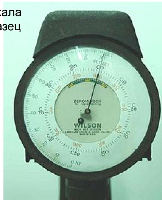
**Шкалу А** применяют для испытания твёрдых сплавов, тонкого листового материала и для определения твердости тонкого верхнего слоя поверхности.
