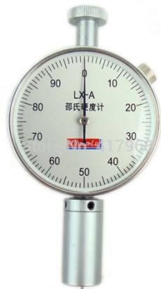
В данном методе измерительный прибор именуется дюрометром.
