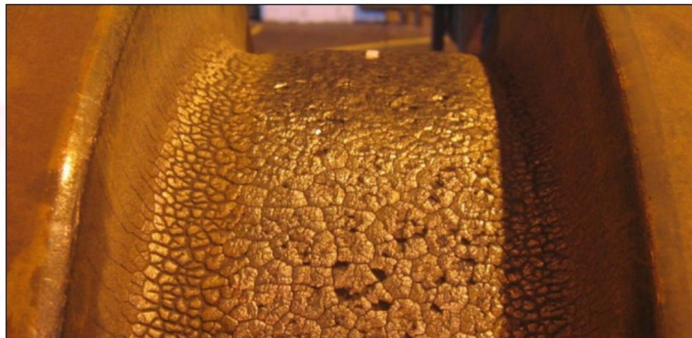
Сетка разгара на дне ящичного калибра сортопрокатного валка
