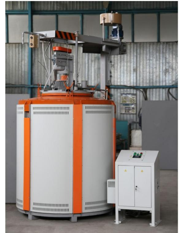
**Азотирование** —это технологический процесс химико-термической обработки, при которой поверхность различных металлов или сплавов насыщают азотом в специальной азотирующей среде.
