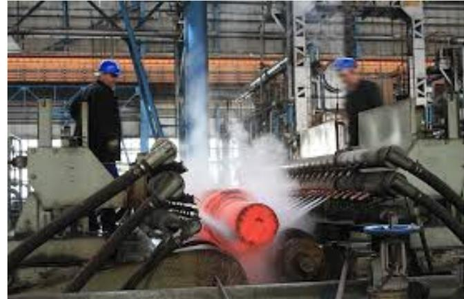
Термическая обработка используется либо в качестве **промежуточной** операции для улучшения обрабатываемости давлением, резанием, либо как **окончательная** операция технологического процесса, обеспечивающая заданный уровень свойств детали (например, высокую твердость, сопротивление износу, меньшую хрупкость, высокую ударной вязкости и т. д.).
