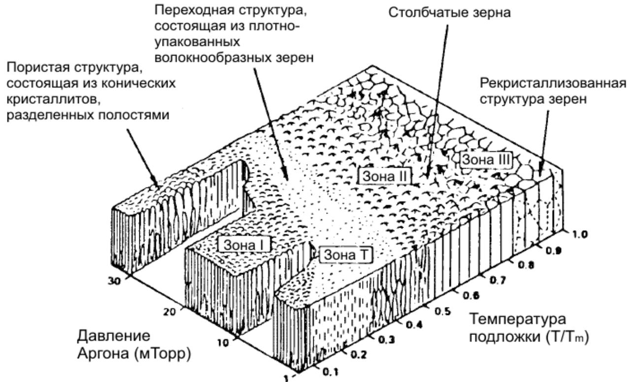
В *Зоне I* нанесенный слой либо является аморфным, либо содержит слабо разориентированные кристаллиты диаметром 5-20 нм.
