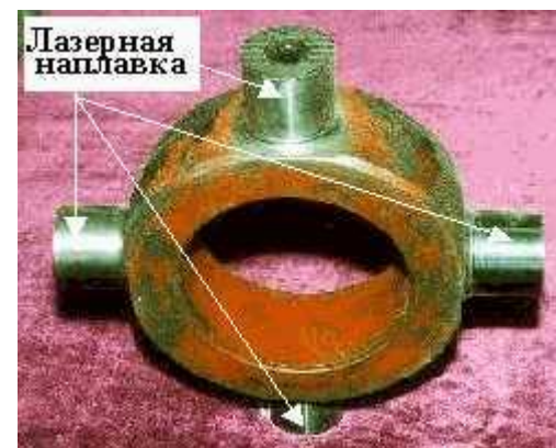
Восстановление изношенных крестовин локомотивов железнодорожного транспорта методом лазерной наплавки.
