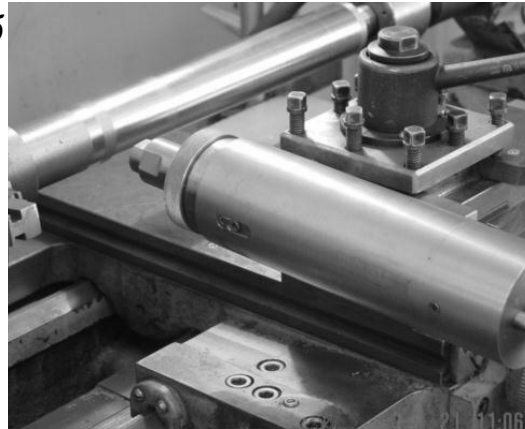
Оборудование для ультразвуковой финишной (а, б) и ударной обработок (в)
