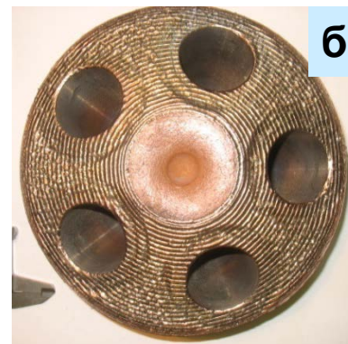
Медный наконечник кислородной фурмы после сварки (а) и последующей наплавки износостойкого покрытия (б)
