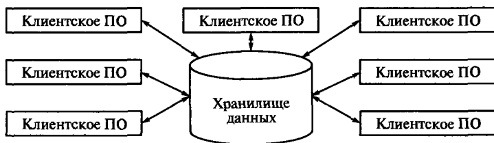
Рис. 2.8. Структура системы, работающей по принципу репозитария
