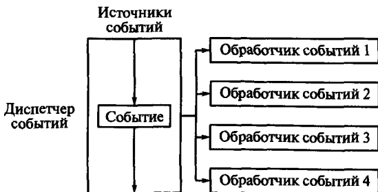
Рис. 2.7. Структура системы, управляемой событиями
