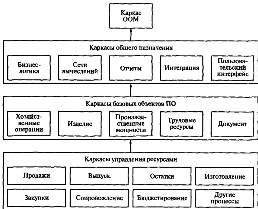
Рис. 7.5. Иерархия каркасов, подразделяющих ЖЦИ
