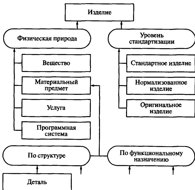
Рис. 7.6. Фрагмент схемы классификации объекта Изделие
