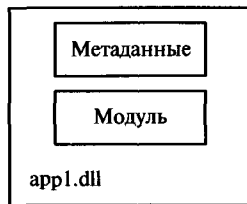
Рис. 4.10. Типовая структура многофайловой сборки
