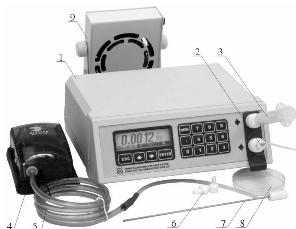
Рис. 1.4. Вибрационный плотномер ВИП-2М:
