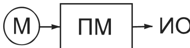
Схема машины: М-двигатель, ПМ-передаточный механизм, ИО-исполнительный орган машины
