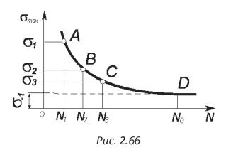
Величину предела выносливости при симметричном цикле определяют на основании опытных данных. Для этого изготовляют серию одинаковых образцов, каждый из которых подвергают действию переменных напряжений. Целью испытаний является определение числа циклов N, при котором разрушается каждый образец. Кривую, построенную по экспериментальным данным в координатах ( $\sigma_{\text{max}}$ , N), называют кривой выносливости (рис. 2.66).
