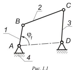
при структурном исследовании механизма. При силовом анализе механизмов разделение звеньев на ведущие и ведомые проводится по знаку элементарной работы сил, действующих на звено. У ведущих звеньев эта работа положительная, у ведомых — отрицательная или равна нулю. Поэтому входное звено, которое в структурном анализе по признаку действия является ведущим, при силовом расчете на различных участках движения мо-
