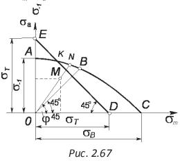
Каждая точка кривой ABC диаграммы характеризует определенный цикл. Точка A соответствует пределу выносливости при симметричном цикле, для которого  $\sigma_m = 0$ , точка C – пределу прочности при постоянном напряжении (здесь  $\sigma_a = 0$ ), а точка B – пределу выносливости при пульсирующем цикле, поскольку при таком цикле  $\sigma_a = \sigma_m$ .
