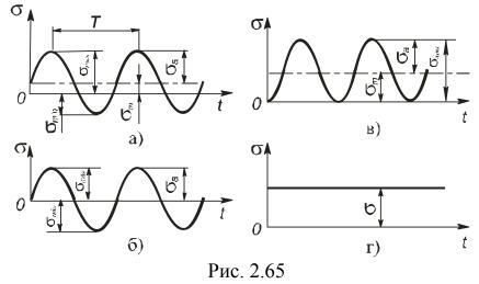
В случае переменных касательных напряжений остаются в силе все приведенные выше термины и соотношения с заменой  $\sigma$  на  $\tau$ ..
