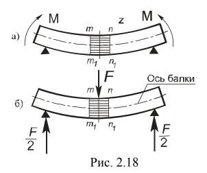
При этом в поперечных сечениях деталей или их элементов возникают изгибающие моменты, т. е. внутренние моменты, действующие в плоскости, перпендикулярной к плоскости поперечного сечения. Такой вид нагружения называют изгибом. Стержни, работающие в основном на изгиб, принято называть балками.
