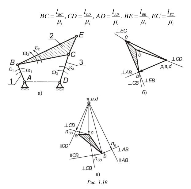
Вычислив длины отрезков, простым геометрическим построением получим план положения механизма для данного значения угла  $\varphi_I$  (рис. 1.19, а). Построив планы положений механизма для n-го количества значений угла  $\varphi_I$  получим траектории движения точек звеньев механизма.
