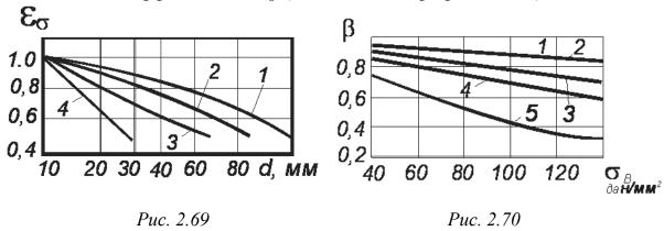
Кривая 1 соответствует детали из углеродистой стали без концентрации напряжений, кривая 2 — то же, но с умеренной концентрацией. При расчете деталей из легированной стали пользуются кривыми 2 и 3 (соответственно при отсутствии и наличии концентрации напряжений). Если деталь имеет большую концентрацию напряжений (типа нарезки), то зависимость  $\varepsilon_{\sigma} = f(d)$  для любой стали изображается кривой 4.
