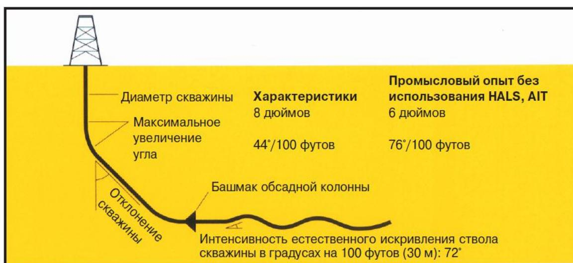
Рисунок 8. Характеристики скважин для применения оборудования PEX [9]
