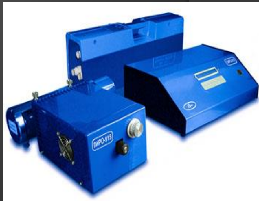
Рисунок 13 - Ртутный анализатор РА-915+ с приставкой ПИРО-915
