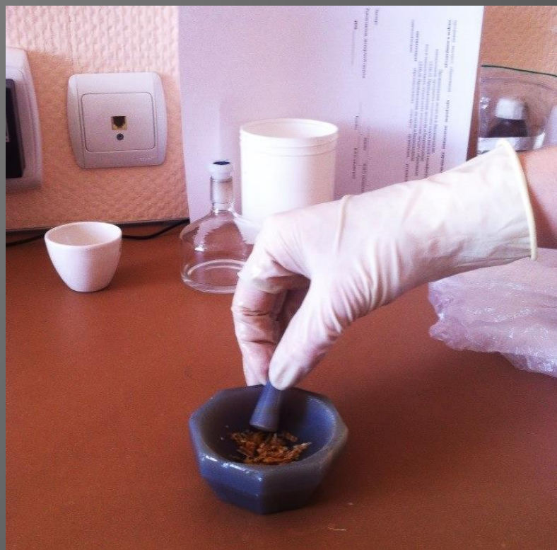
Рисунок 12 - Измельчение костной ткани речного окуня в агатовой ступке
