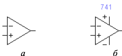
Рис. 13.9. Модели операционных усилителей. а – идеальный, без выводов питания; б – серийный, с выводами питания
